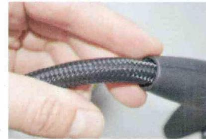
▲ Flexschläuche sind resistenter gegen Knicke - und an Haupt- und Zweitautomat verbaut.
